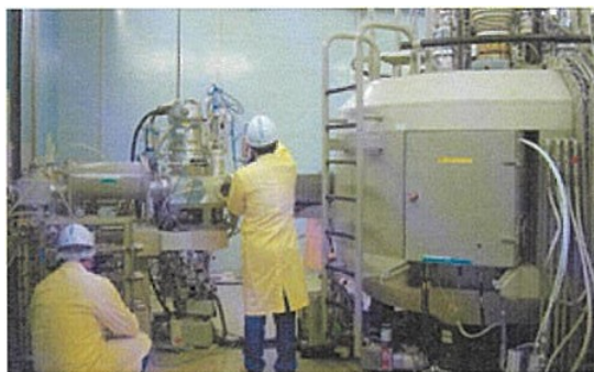
図7 加速器の点検
